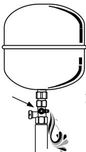
3. Откройте сливной кран для удаления жидкости из расширительного бака. Теперь можно выполнять работы или заменить расширительный бак.
