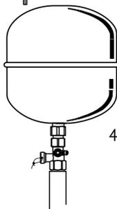
4. По окончании работ с расширительным баком закройте сливной кран, откройте вентиль, закройте его крышкой и опломбируйте новой пломбой.
