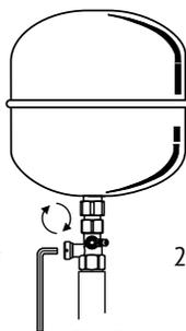
2. С помощью торцевого ключа на 5 мм закройте вентиль по часовой стрелке.
