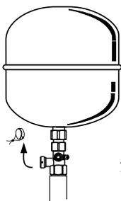
1. Снимите пломбу и крышку вентиля.
