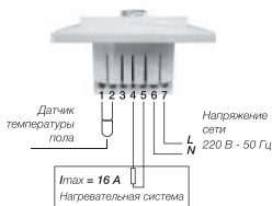
Рисунок 4. Схема подключения к терморегулятору
